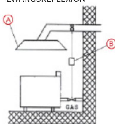
Die Entlüftung der Haube erfolgt über eine separate Abzugshaube des Schornsteinkörpers. Der Abzug der Rauchgase wird gewährleistet durch naturzugschornstein
